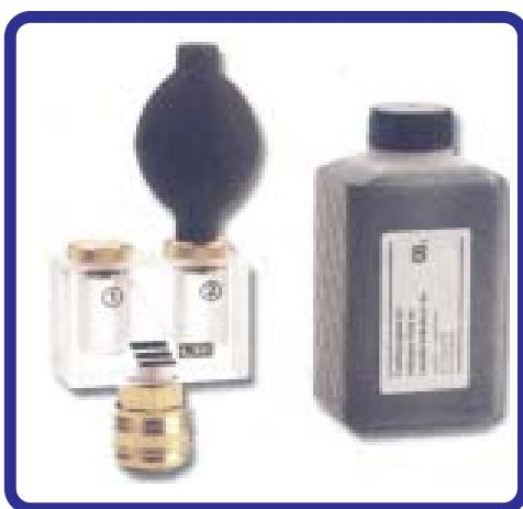
Подтекание прокладки головки цилиндра или головки цилиндра обозначается изменением цвета проверочной жидкости с голубого на желтый (бензиновые двигатели), с голубого на зеленый (дизельные двигатели).
