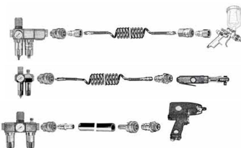
Установки технического обслуживания с лубрикатором (узким или широким) для всех инструментов, которым требуется постоянная смазка.
